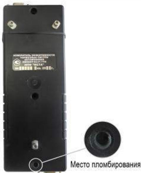
Рисунок 4 – Место пломбирования электронного блока
