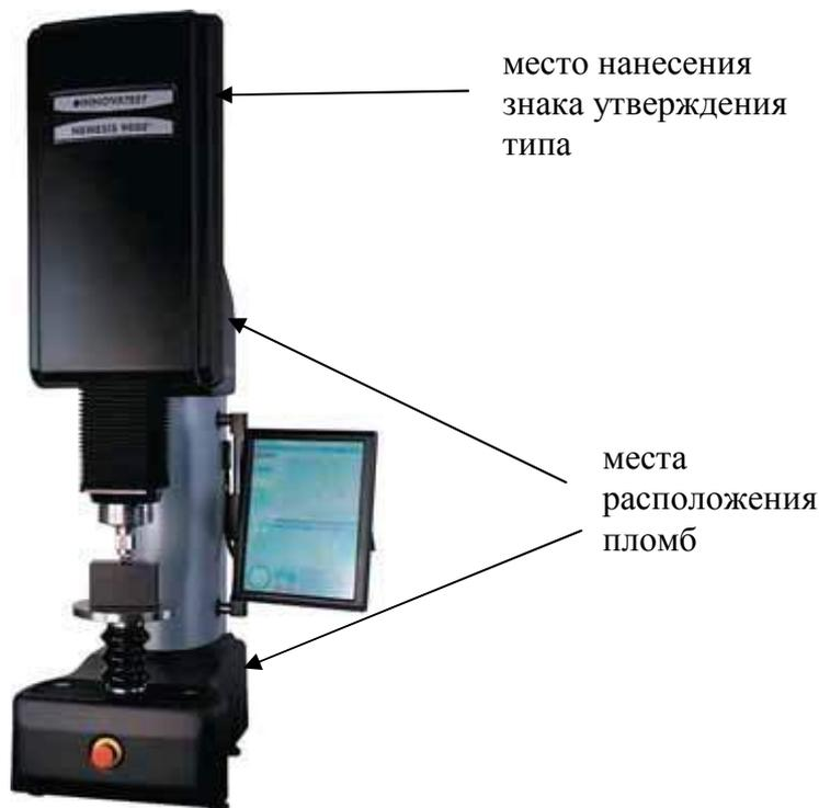
Рисунок 1 – Внешний вид твердомеров
