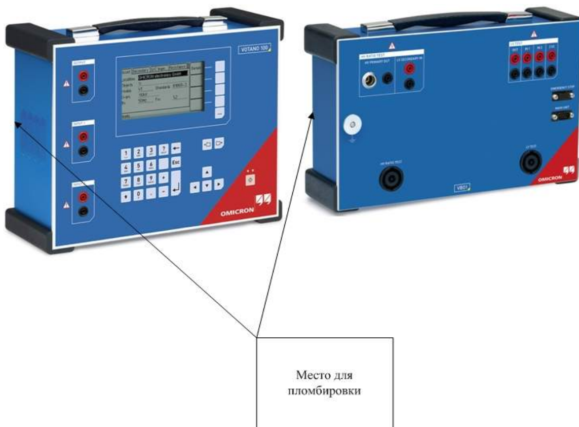
Рисунок 2 Фотография мест пломбировки системы испытательной.
