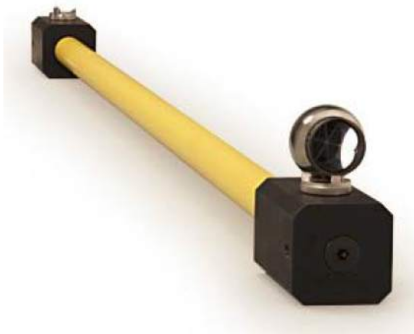
Рисунок 2 – Общий вид мер неразборных с отражателями (а- мера без установленных отражателей, б- мера с установленными отражателями).
