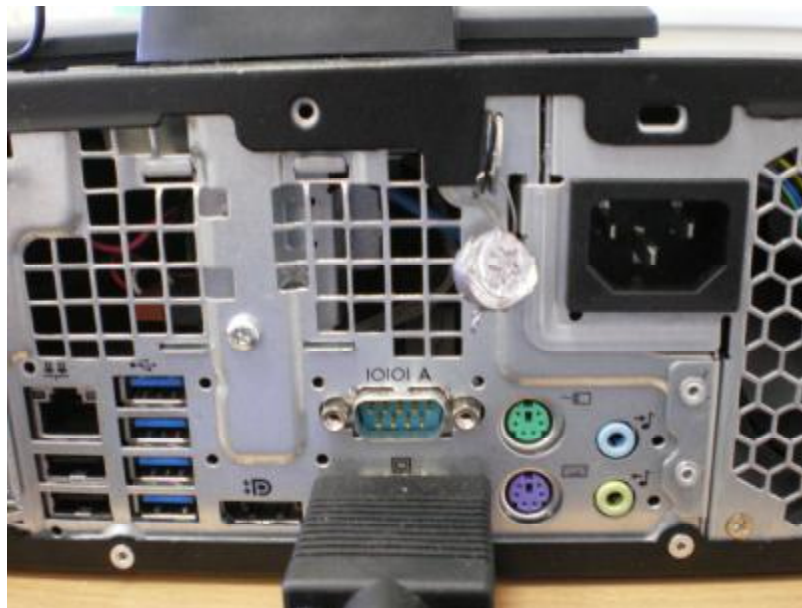
Рисунок 4 Место опломбирования компьютера АРМ диспетчера швартовки
