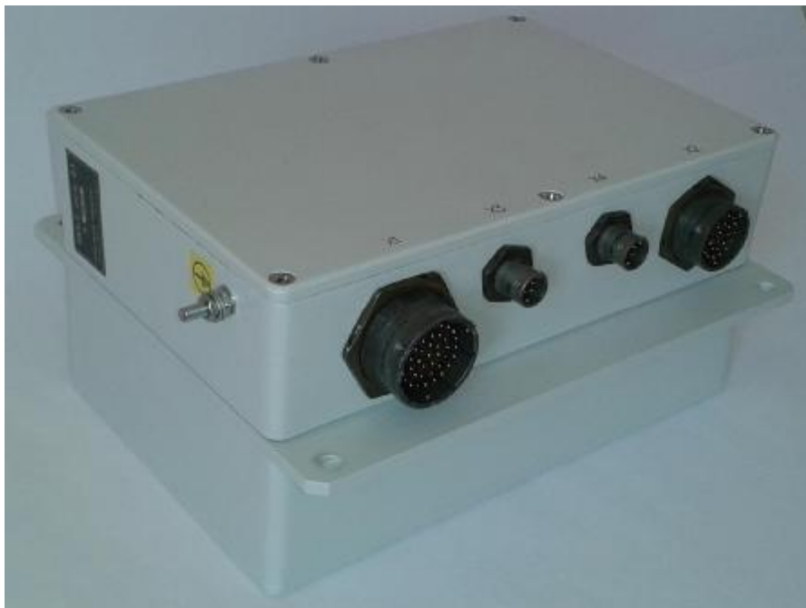
Рисунок 1- Фотография общего вида преобразователей нормирующих НП-1
