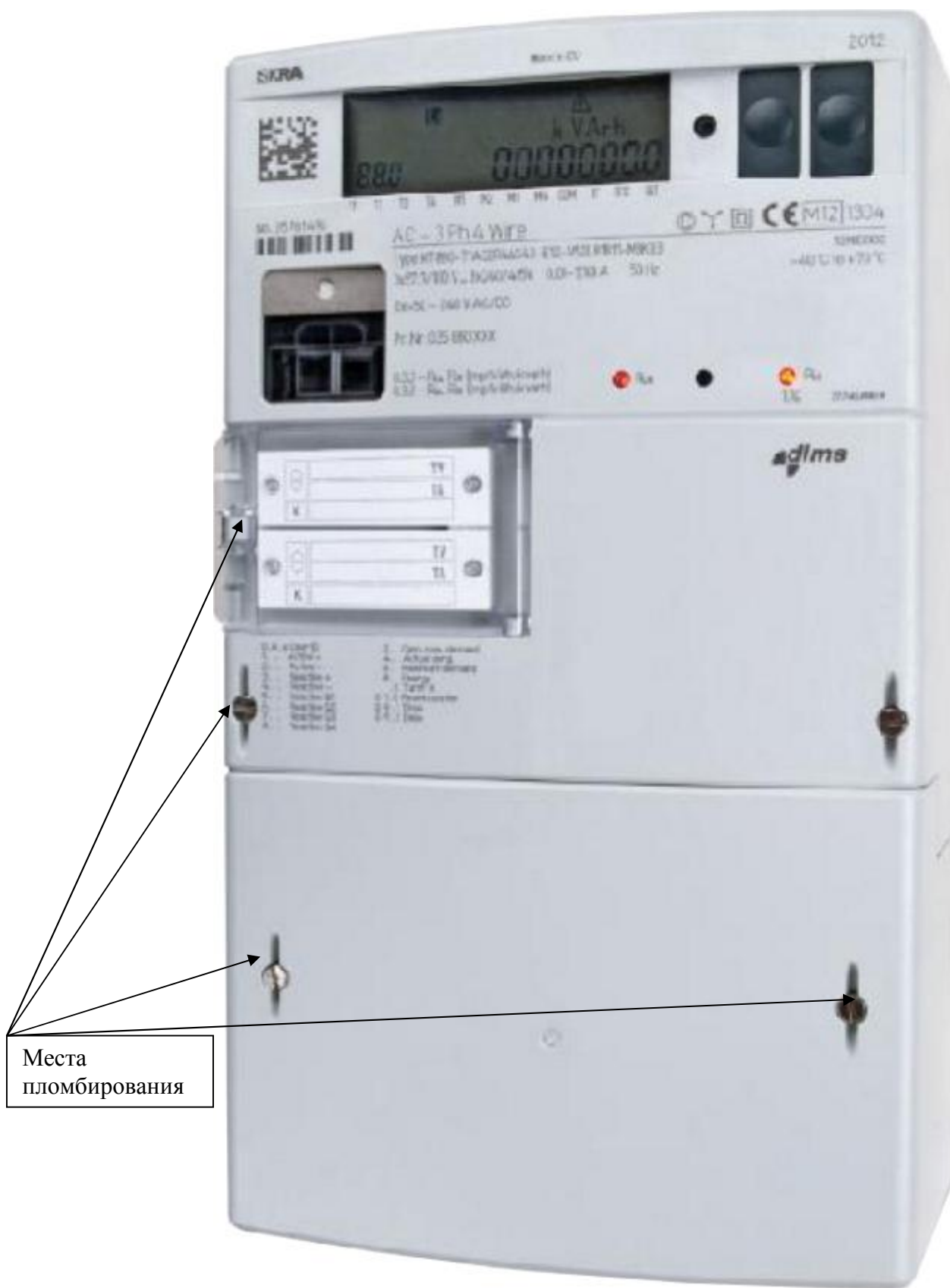
Рисунок 1 – Счетчик статический трехфазный переменного тока активной и реактивной энергии MT880 исполнений MT880-...-I
