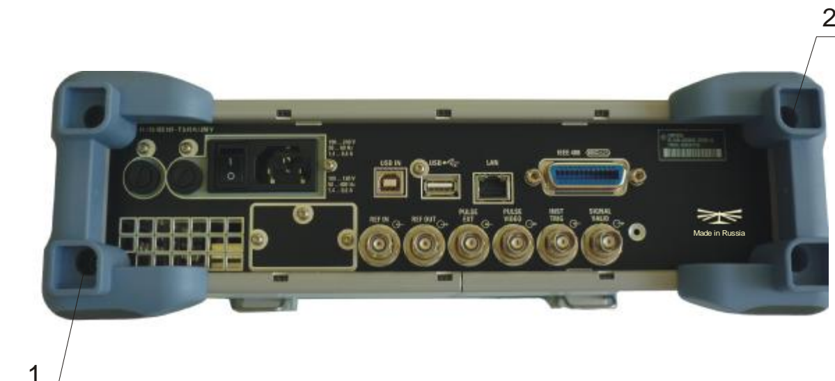
Рисунок 2 – Схема пломбирования от несанкционированного доступа
