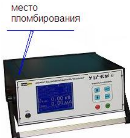
Общий вид установок высоковольтных измерительных «ПрофКиП УПУ-10М»
