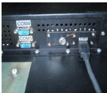
Рисунок 3 –Схема пломбировки БУ
