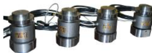
Рисунок 2 – Общий вид тензодатчиков с узлами вставки
