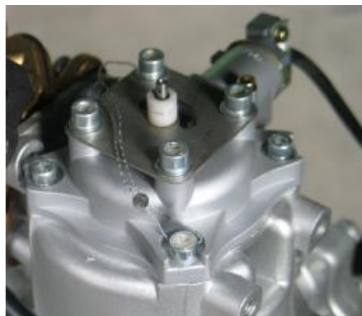
Рисунок 4 - Пломбировка датчика импульсов PS100
