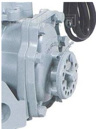
Рисунок 3 - Пломбировка измерителя объема поршневого типа LPGFM1B
