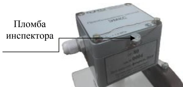
Рисунок 3 – Место пломбирования инспектором
