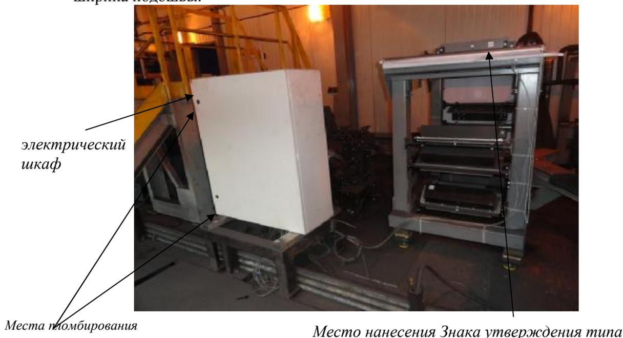
Рисунок 1 - Общий вид Измерителя
