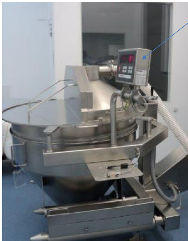
Рисунок 2 - Внешний вид весов специальных подъемных ZSB-Dorn-300-E-S и размещенным на них бункером BWT 300
