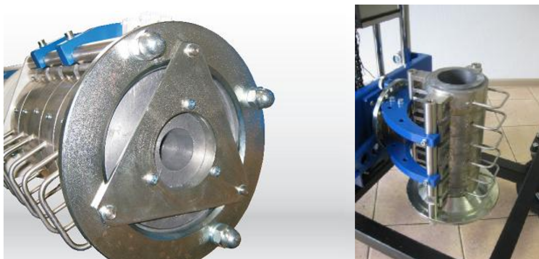
Рисунок 4 - Внешний вид съемных коллиматоров толщиной 100 мм и 50 мм для модификации DIGIBASE CART.
