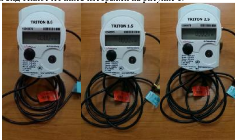
Рисунок 1 – Внешний вид теплосчетчиков «TRITON»
