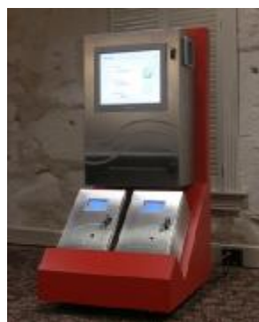
б) ЦПУ и преобразователь расхода (модификация CheckPlus C)
