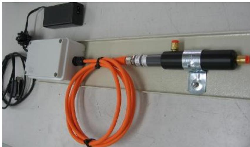
Рис. 2 Фотография общего вида внешнего датчика газоанализаторов Serinus 30/CO<sub>2</sub>.
