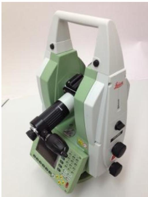
Рисунок 1 – Вид теодолита со стороны панели управления
