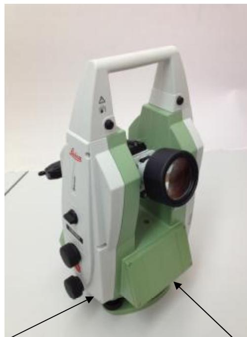
Рисунок 2 – Вид теодолита со стороны передней панели
