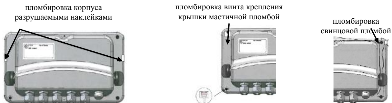
Рисунок 3 — Схема пломбировки приборов i 20, i 30, i 35, i 40-SS
