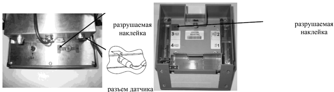
Рисунок 5 — Схема пломбировки приборов I 200
