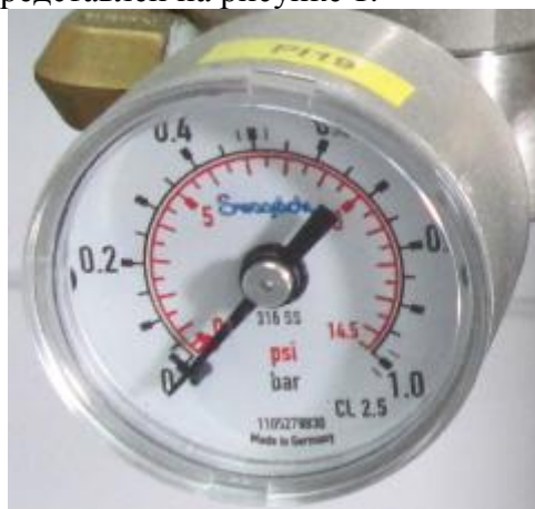
Рисунок 1. Манометр показывающий модели PGI-40M-BG1-CANX.
