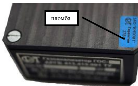
Рисунок 3 – Схема пломбировки газоанализаторов
