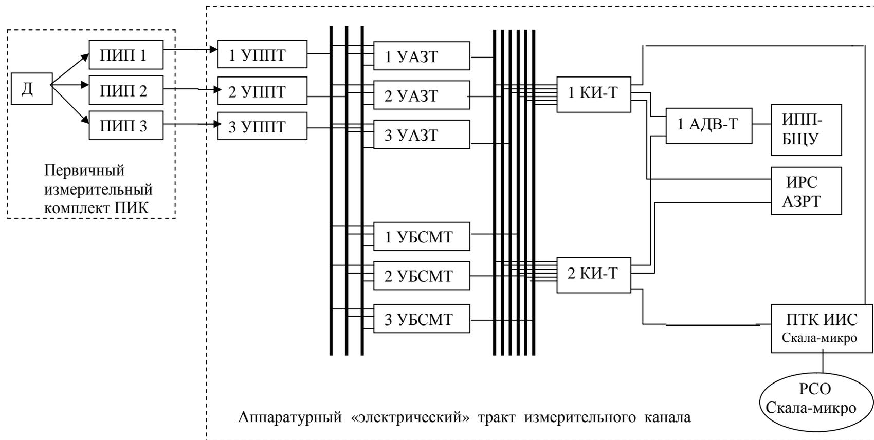
Рисунок 2 – Структурная схема первого комплекта АЗРТ
