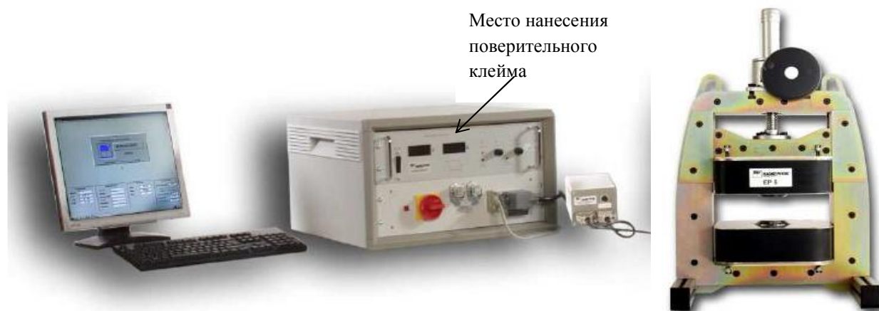
Рисунок 1 - Внешний вид гистерезисграфа с электромагнитом EP 5
