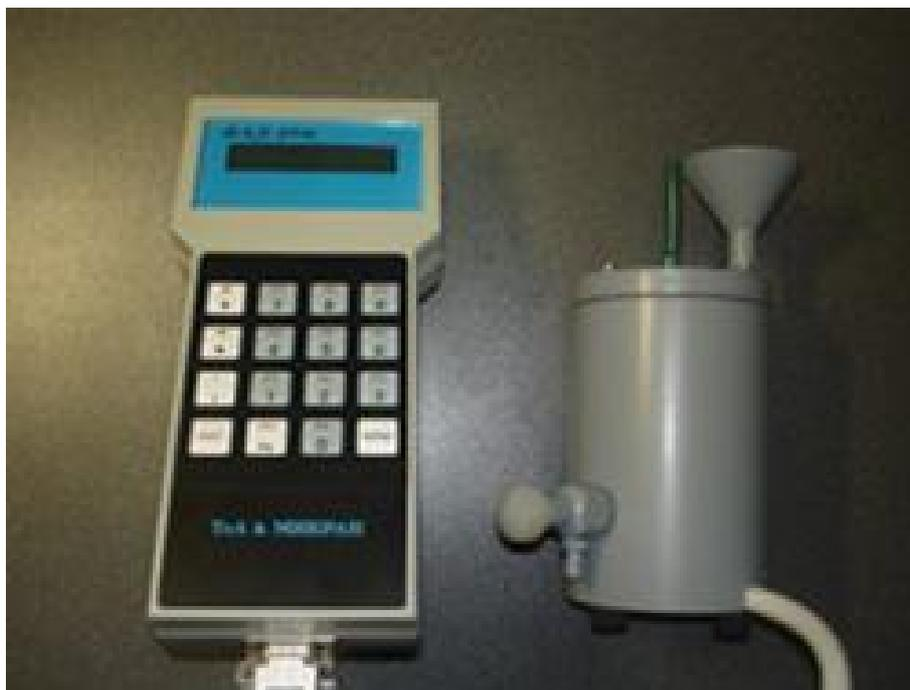
Рисунок 2. Анализатора ВАД-40М с выносными датчиком вместимостью 220 см<sup>3</sup>
