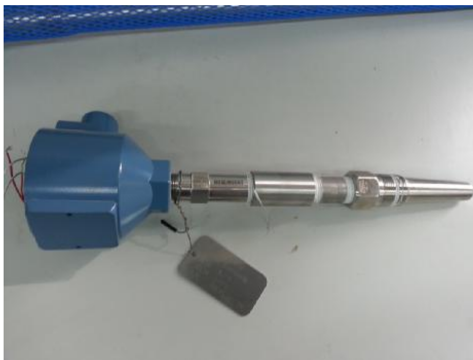
Рис. 1 – Термопреобразователь сопротивления платиновый Rosemount исполнения 0078D21A30B025T26
