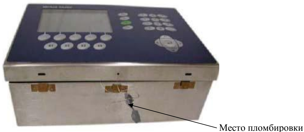
Рисунок 3 - Схема пломбировки для настольного исполнения терминалов
