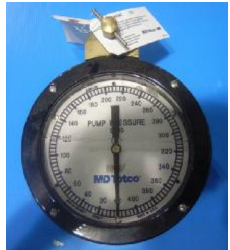
Рис. 2. Манометр GM6A(C), монтаж на кронштейне
