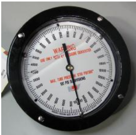
Рис. 3. Манометр DBS112A(113A), монтаж в панель
