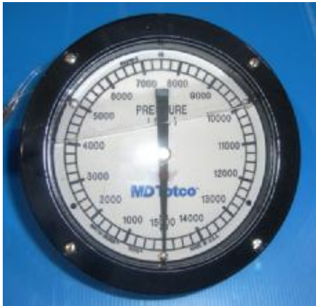
Рис. 1. Манометр GM6AP, монтаж в панель
