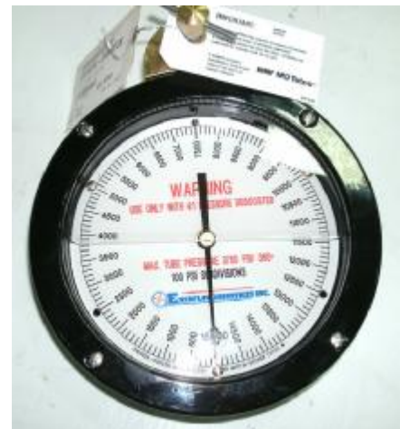
Рис. 4. Манометр DBS107A, монтаж на кронштейне
