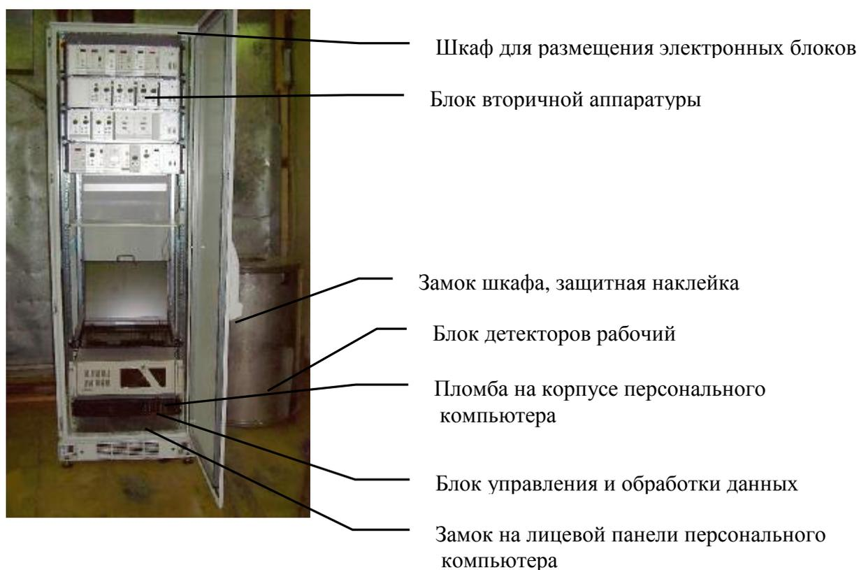
Рисунок 3- Внешний вид модуля электронного
