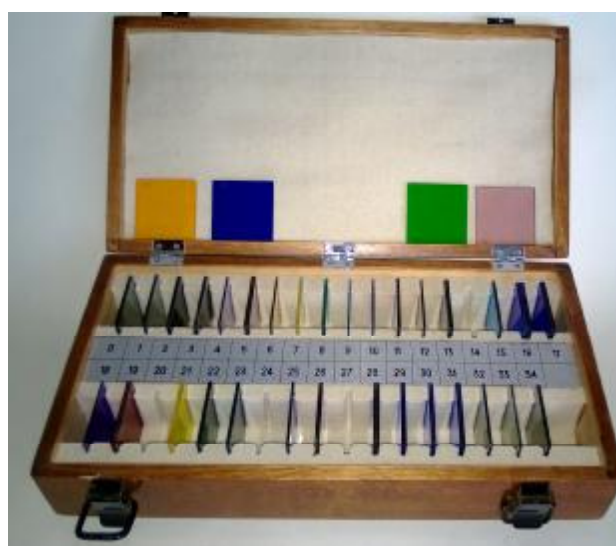
Рисунок 1 – Общий вид набора мер пропускающих координат цвета и цветности НМПЦ-01 с обозначением места маркировки
