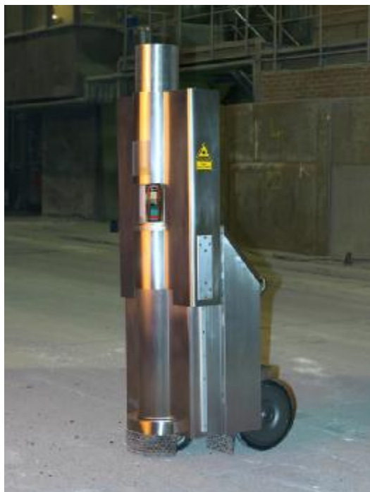
Рисунок 1 – Сканер лазерный LaCam ® -М
