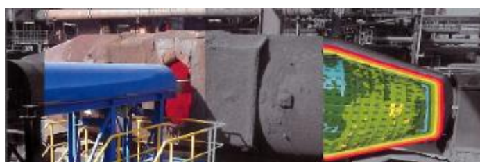
Рисунок 3 - Сканер лазерный LaCam ® -Torpedo
