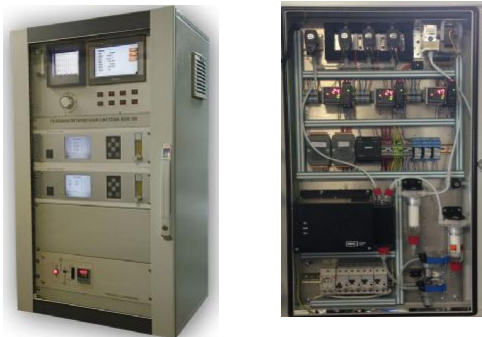
Рис.1. Внешний вид системы газоаналитической SGS-100 с установленной на задней стенке шкафа системой пробоподготовки.
