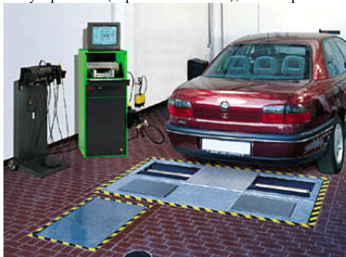
Общий вид комплексов измерительных для диагностирования тормозной системы и подвески автотранспортных средств
