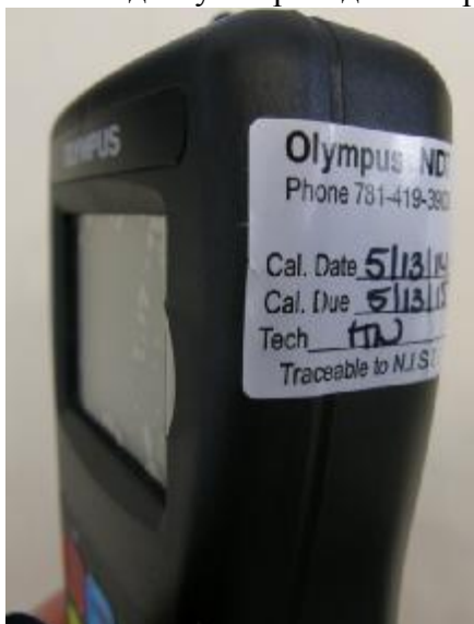
Рисунок 2 - Схема пломбировки от несанкционированного доступа
