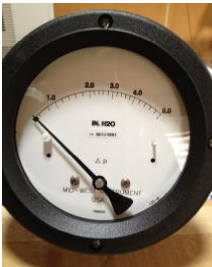
Рисунок 1. Фотография манометра дифференциального модель 130SC-00-(FU)O.
