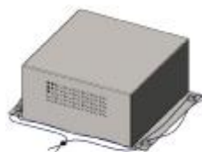
Рис.1. Пломбировка крышки датчика импульсов (навесная пломба с клеймом поверителя)
