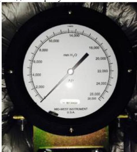
Рисунок 1. Фотография манометра дифференциального модель 109QE-10-(FUY)O.
