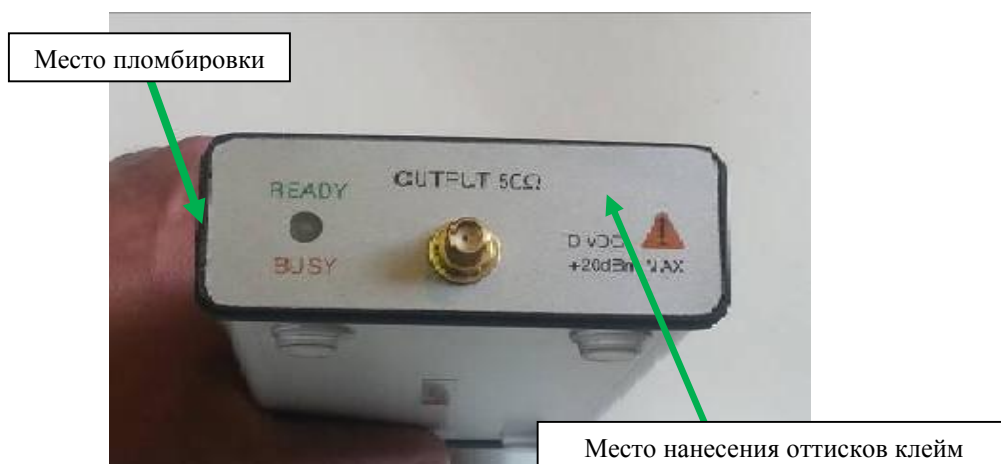
Рисунок 2 - Схема пломбировки от несанкционированного доступа и нанесения оттисков клейм
