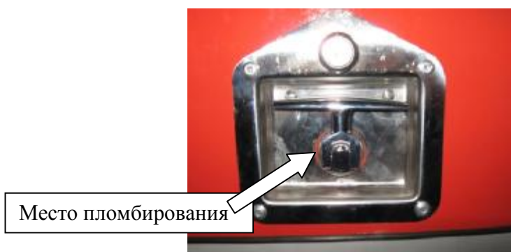
Рисунок 7 – Ручка открывания технологического отсека, или заглушка открывания трубопровода слива топлива из АТЗ (в зависимости от конструктивного исполнения)
