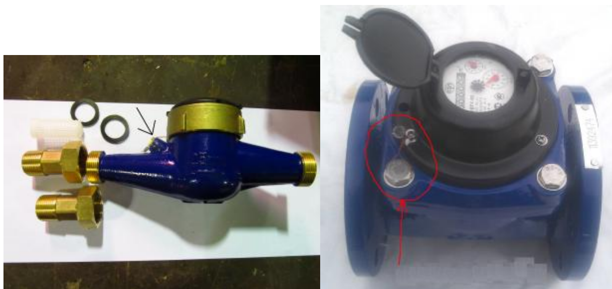
Рисунок 2 – Места пломбирования счетчиков
