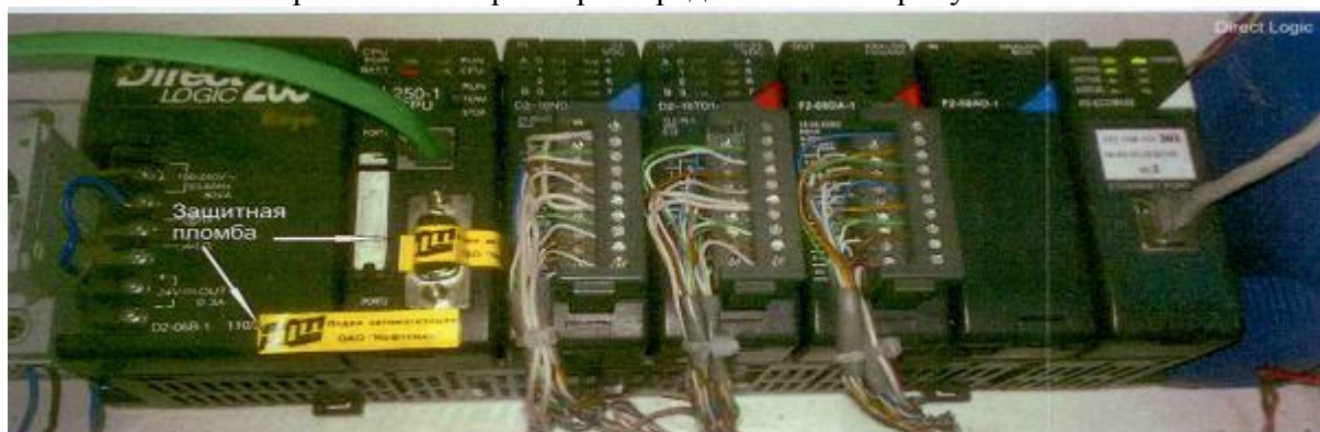
Рисунок 2 – Схема пломбирования контроллера «Direct Logic»
