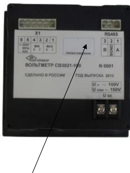
Рисунок 3 - Место нанесения поверительного клейма
