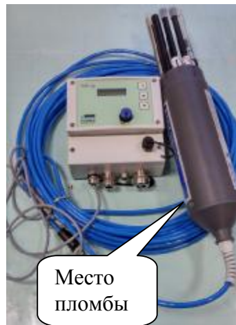
Рис.1. Внешний вид анализатор для контроля качества воды MPS-Qualilog-16. Вид пломбы.
