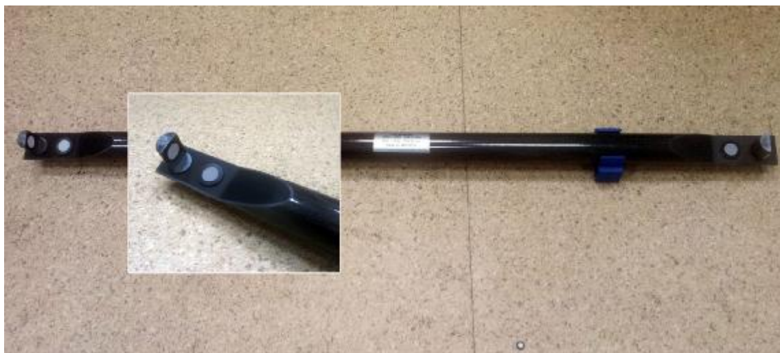
Рисунок 1(б) - Общий вид мер с маркерными метками, расположенными в 2-х взаимно перпендикулярных плоскостях.
