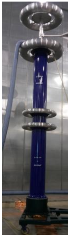
Рисунок 1. Внешний вид делителя напряжения высоковольтного ТАWF 15000/450
