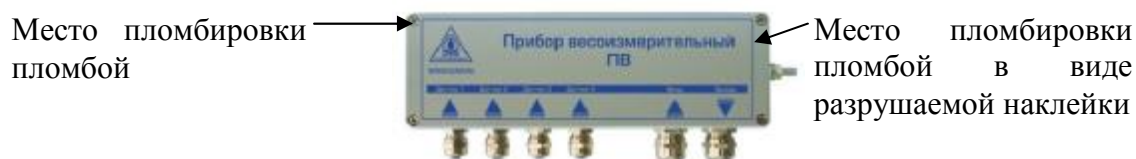
Схемы пломбировки ПВ-15
