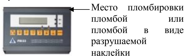
Схемы пломбировки ПВ-22
