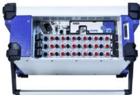
Рисунок 3 Фото общего вида многоканальных модульных устройств сбора данных GEN3t
