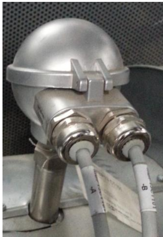
Рис. 1. Внешний вид термопреобразователя сопротивления платинового модели DB812.20.
