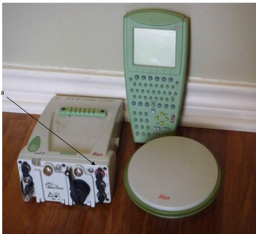
Рисунок 1 – Вид опорной эталонной станции GRX 1200 GG Pro а) место нанесения наклейки со знаком утверждения типа
