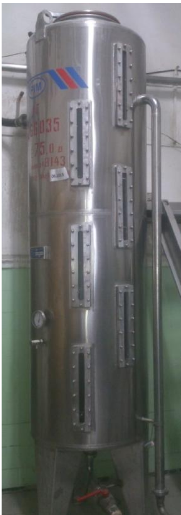
Рисунок 1. Общий вид мерника V=0,75 \text{ м}^3 № 5166.035
