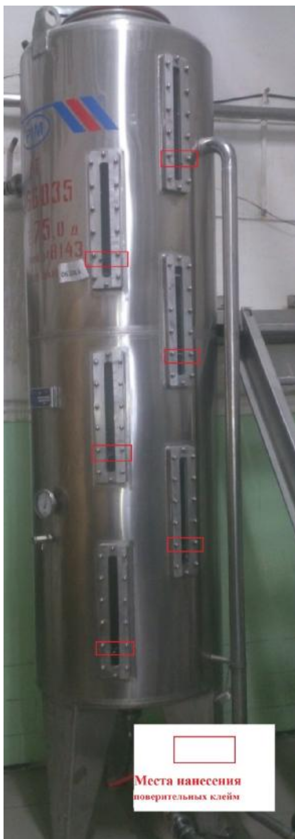
Рисунок 7. Места нанесения поверительных клейм мерника V=0,75 \text{ м}^3
